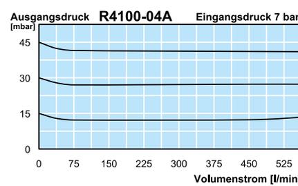
\*1 bei 10 bar Eingangsdruck und max. Ausgangsdruck, \*2 B6 = 0...60 mbar, C2 = 0...160 mbar, C3 = 0...250 mbar, C4 = 0...400 mbar
